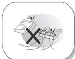
No conecte demasiados cables de corriente en un zócalo de enchufes. Puede provocar fuego o un cortocircuito.
