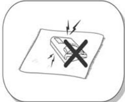
Evite situar el teléfono en sitios en los que se puedan producir descargas electrostáticas. Puede provocar una avería del terminal.
